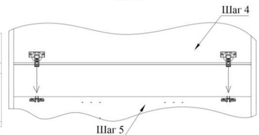
Верхнюю часть петли с креплением быстрого монтажа вставить в пазы ответной планки, зафиксировать нажатием сверху (по необходимости отрегулировать ответным винтом).
