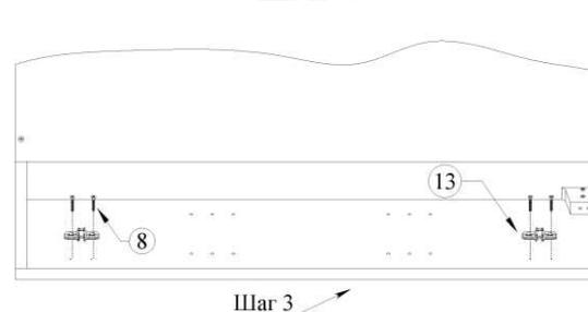
Прикрутить ответные планки петель (13) при помощи саморезов 4x16 (8) в размеченные под них отверстия в боковую стенку шкафа
