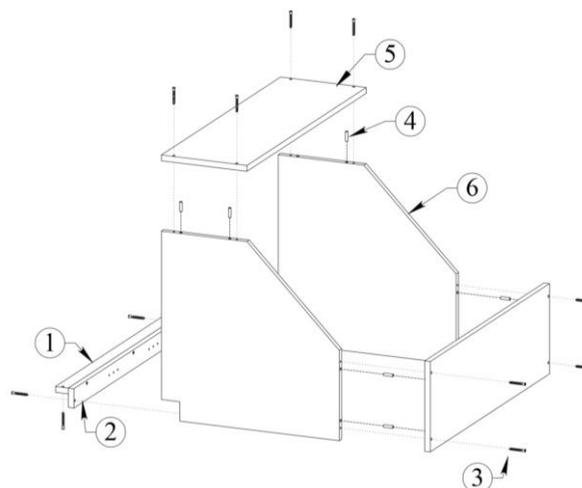
Рейки 42x18 (1) и 60x18 (2) скрепить конфирматами (3), затем при помощи шкантов (4) и конфирматов соединить боковые стенки (5), основания (6) и рейки 1 и 2
