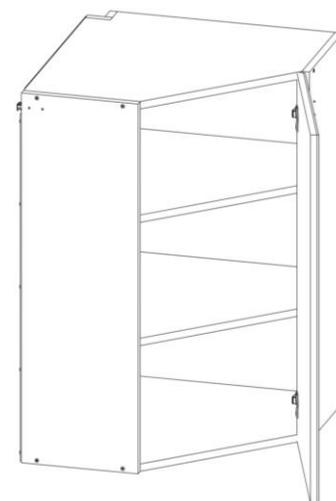
Вставить полкодержатели в отверстия боковых стенок, под углом вставить полки в шкаф и установить их на полкодержатели
