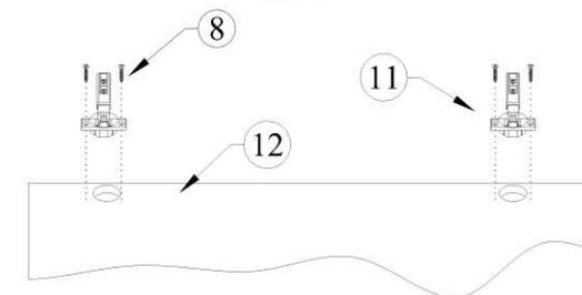
Разъединить чашу и ответную планку петель скрепленные между собой. Вставить чаши петель (11) в отверстия в фасаде (12), после чего закрепить чаши при помощи саморезов 4x16 (8)
