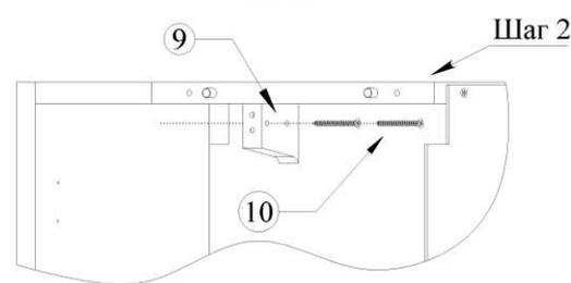
Установить в верхние углы кухонные навесы (9), закрепить их при помощи саморезов 4x30 (10)
