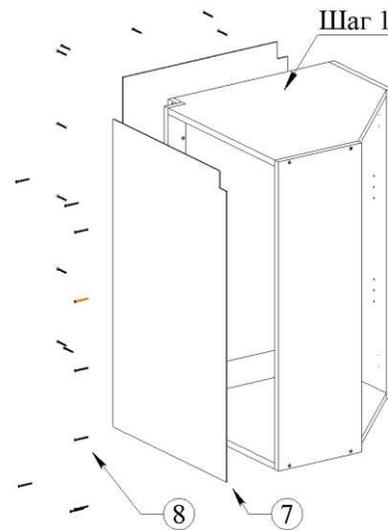
Притянуть задние стенки (7) к корпусу шкафа (шаг 1) саморезами 4x16 (8)
