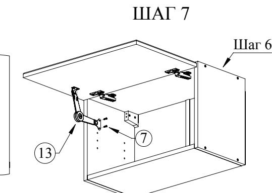
Прикрутить саморезами 4x16 мебельный кронштейн (13) к боковой стенке шкафа и фасаду в соответствии с инструкцией входящей в комплект кронштейна
