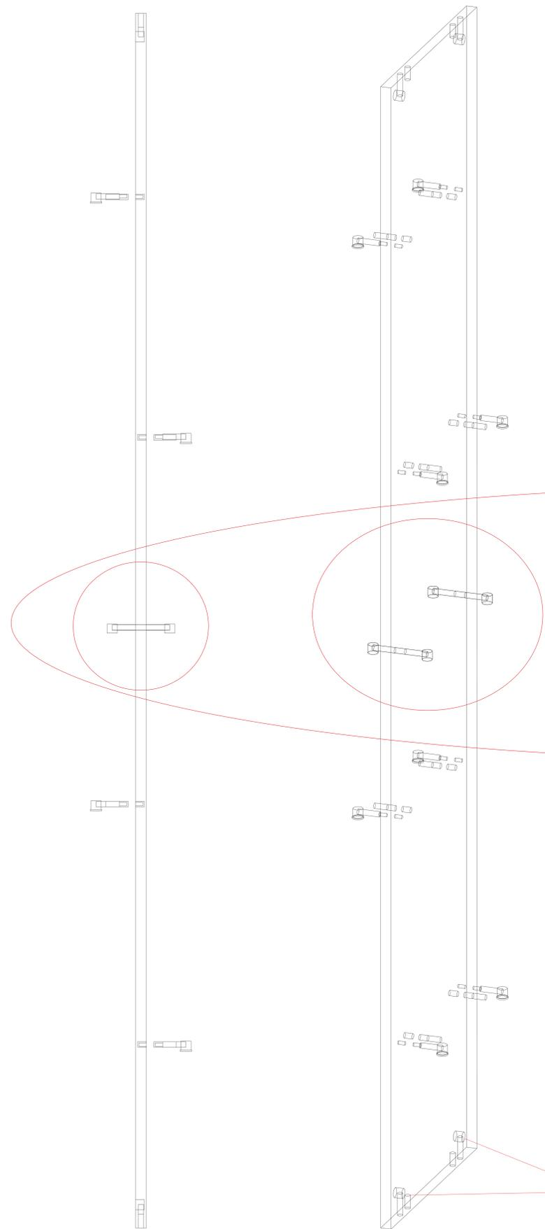
Отверстие для установки **двустороннегo эксцентрикового винта**
