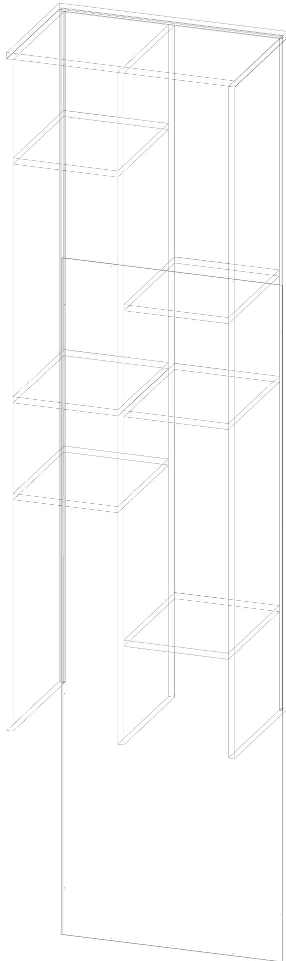
**Нижняя деталь с цоколем устанавливается после монтажа задней стенки.**
