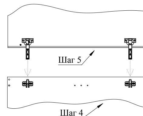
Верхнюю часть петли с креплением быстрого монтажа вставьте в пазы ответной планки, зафиксируйте нажатием сверху (по необходимости отрегулировать крепежным винтом).
