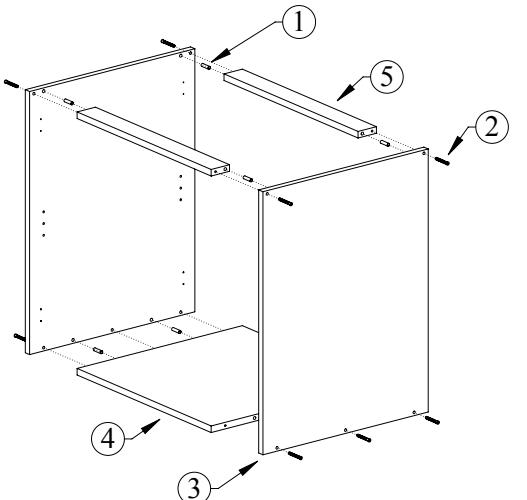
При помощи шкантов (1) и конфирматов (2) скрепите в единую конструкцию боковые стенки (3), основания (4) и поперечины (5)
