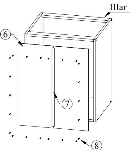
Соедините задние стенки (6) с помощью соединительной планки (7), затем притяните их к корпусу шкафа (шаг 1) саморезами 4x16 (8)
