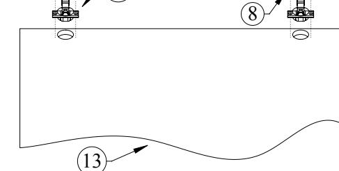
Вставьте чаши петель (12) в отверстия фасадов (13), после чего закрепите чаши при помощи саморезов 4x16 (8)
