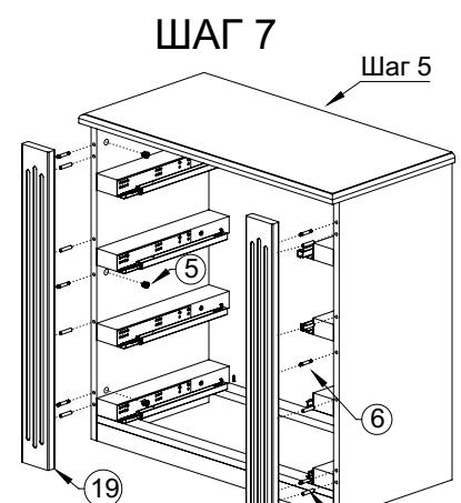
Установить и закрепить фиксаторы (18). Притянуть декоративные планки (19) саморезами 3,5x15 как показано на рисунке. к корпусу комода при помощи шкантов и эксцентриков.
