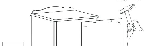
Установить заднюю стенку и закрепить при помощи молотка и гвоздей
