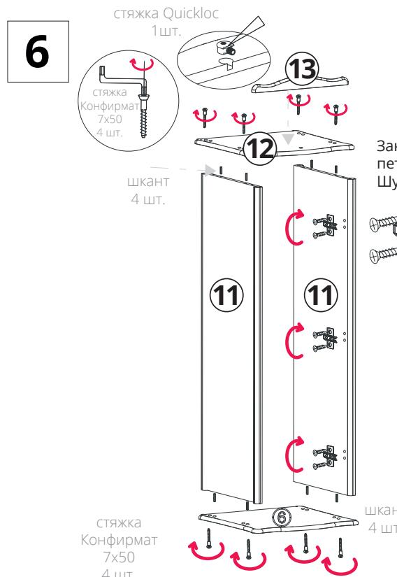
Закрепить Ответные планки петли 4x шарнирной Шурупами 3,5x16
