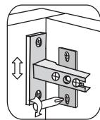
Винт для регулировки дверей по высоте
