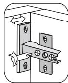
Винт для боковой регулировки дверей
