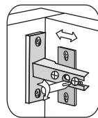
Винт для фронтальной регулировки дверей
