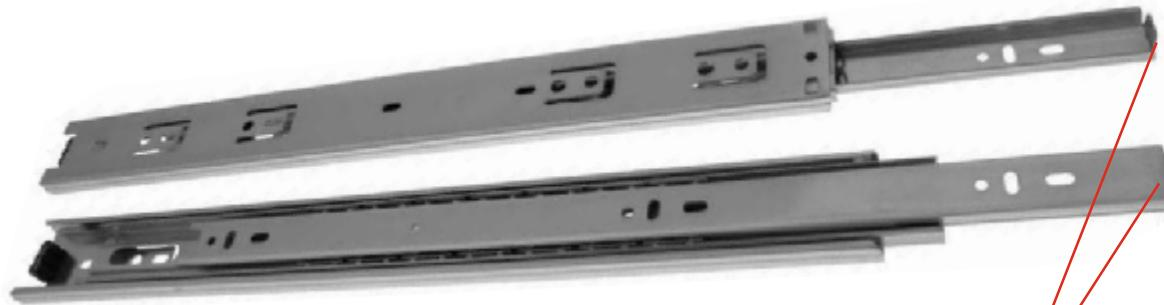
Для установки направляющих на корпус и боковины ящиков, необходимо вытянуть **узкую планку направляющей**, с обратной стороны надо поджать черный пластиковый флагжок и можно вытягивать узкую деталь от направляющей.
