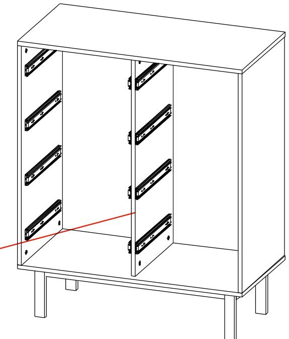
**!** Обязательно соблюдайте последовательность сборки в инструкции. Верхняя крышка корпуса устанавливается после монтажа задней стенки.
