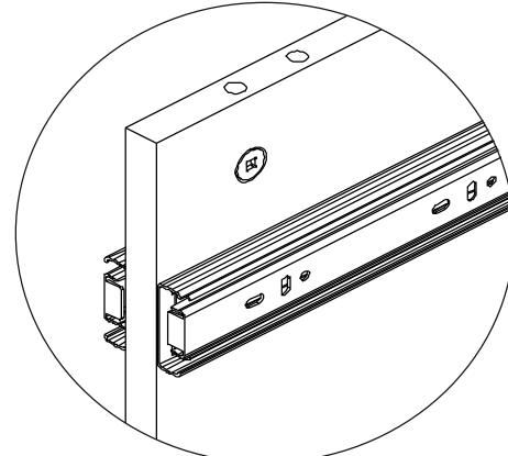
На центральных частях корпуса **направляющие** устанавливаются **с обеих сторон детали**
