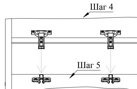
Верхнюю часть петли с креплением быстрого монтажа вставьте в пазы ответной планки, зафиксируйте нажатием сверху (по необходимости отрегулировать крепежным винтом).
