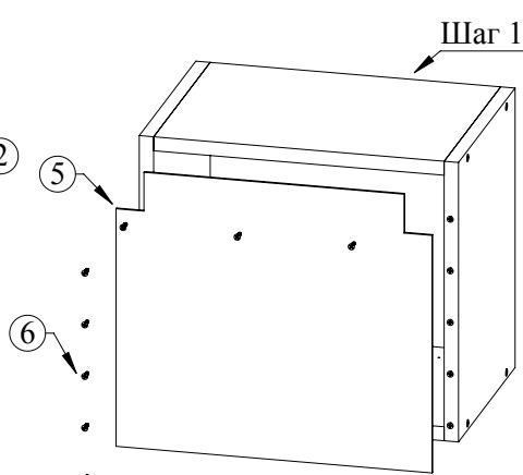
Притяните заднюю стенку (5) к корпусу шкафа (шаг 1) саморезами 4x16 (6)
