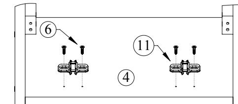
Прикрутите ответные планки (11) петель при помощи саморезов 4x16 в размеченные под них отверстия в верхнее основание шкафа.
