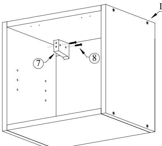
Установите в верхние углы шкафа кухонные навесы (7), закрепите их при помощи саморезов 4x30 (8)
