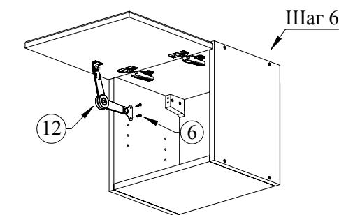
Прикрутить саморезами 4x16 мебельный кронштейн (12) к боковой стенке шкафа и фасаду в соответствии с инструкцией входящей в комплект кронштейна
