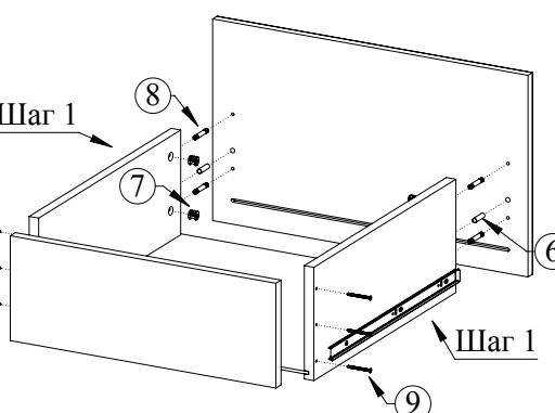
При помощи шкантов (6), эксцентриковой стяжки [эксцентрик (7), шток эксцентрика (8)] и саморезов 4x30 (9) скрепите в единую конструкцию стенки, днища и фасады ящиков
