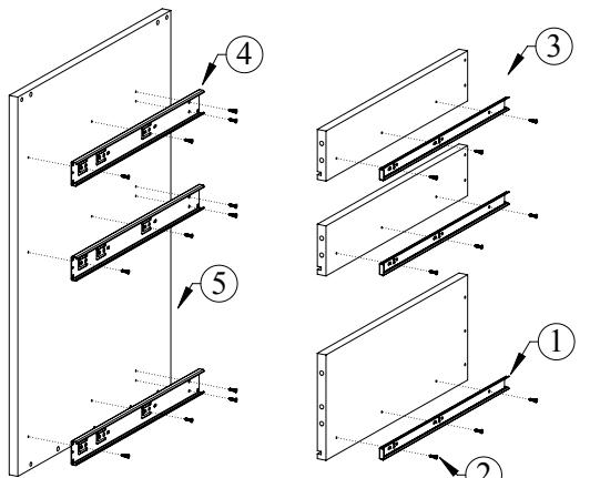
У направляющих нажмите на деблокировочный рычаг, который находится внутри подвижной планки. Снимите внутренние подвижные планки (1) и прикрутите их саморезами 4x16 (2) к боковым стенкам ящиков (3), а внешние неподвижные планки (4) к боковым стенкам тумбы (5)
