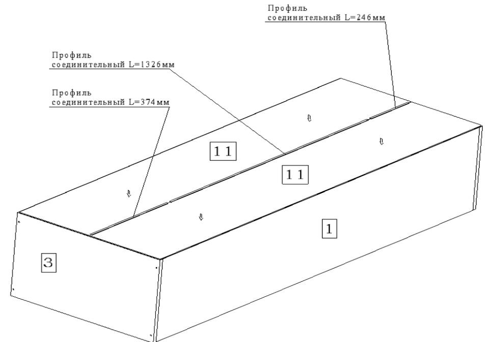
11. Закрепить деталь 11 гвоздем 2x20 и шурупом 3.5x20.
