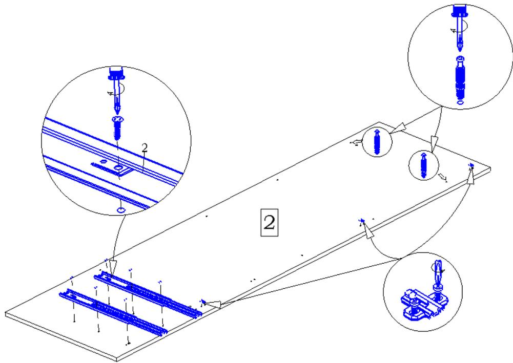
4. В полку 5 вставить эксцентрики и шканты 8x30. Шурупом 4x16 закрепить штангу выдвигающую.
