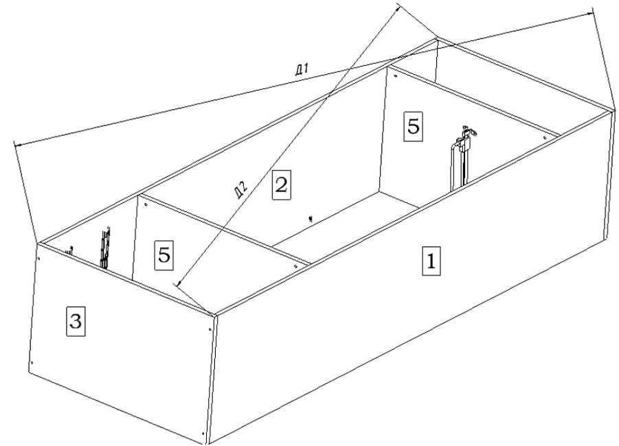
10. На собранный корпус шкафа установить заднюю стенку 11. Затем установить профиля соединительные и заднюю стенку 11.
