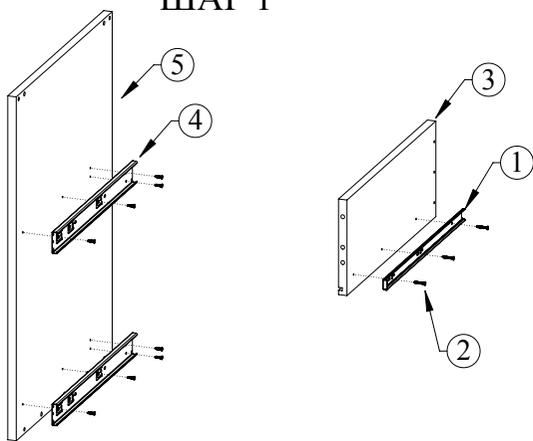
У направляющих нажмите на деблокировочный рычаг, который находится внутри подвижной планки. Снимите внутренние подвижные планки (1) и прикрутите их саморезам 4х16 (2) к боковым стенкам ящиков (3), а внешние неподвижные планки (4) к боковым стенкам тумбы (5)
