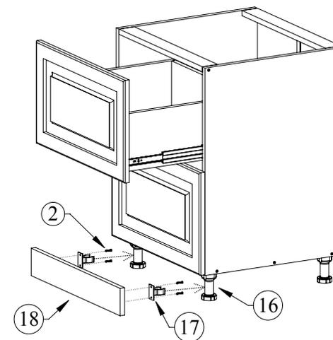
Вставьте ящик внутренними направляющими в подвижные части внешних направляющих в корпусе тумбы. Задвиньте ящик до фиксации деблокировочным рычагом. Для снятия ящика также используйте деблокировочный рычаг. Прикрепите клипсы (17) к цоколю (18) саморезами 4х16 (2), затем при помощи клипс прикрепите цоколь к ножкам (16)
