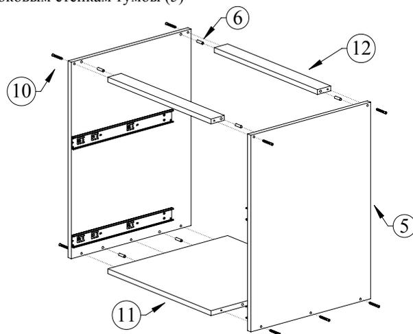
При помощи шкантов (6) и конфирматов (10) скрепите боковые стенки (5), основание (11) и поперечины (12)
