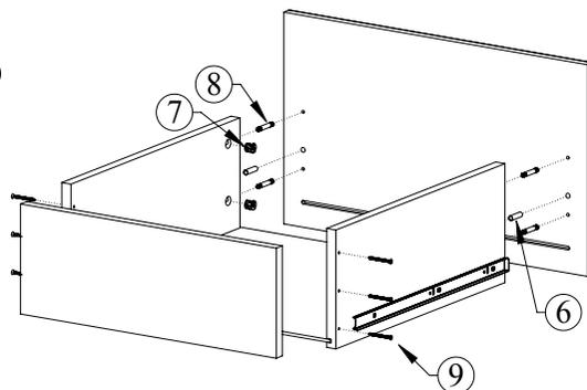
При помощи шкантов (6), эксцентриковой стяжки [эксцентрик (7), шток эксцентрика (8)] и саморезов 4х30 (9) скрепите в единую конструкцию стенки, дно и фасад ящика
