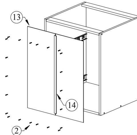
Соедините задние стенки (13) с помощью соединительной планки (14), затем притяните их к корпусу шкафа (шаг 3) саморезами 4х16 (2)
