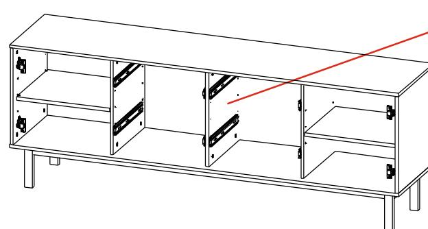
На центральных частях корпуса **направляющие** устанавливаются **с обеих сторон детали**
