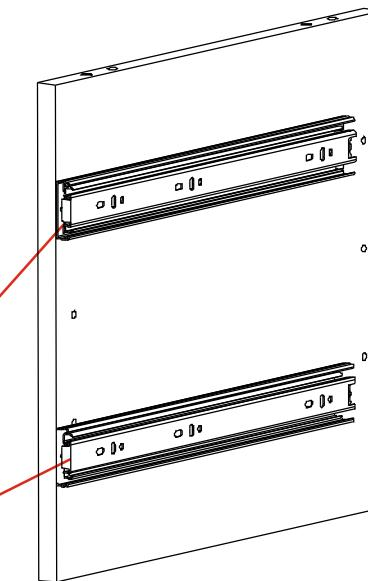
На центральных частях корпуса **направляющие** устанавливаются **с одной стороны**
