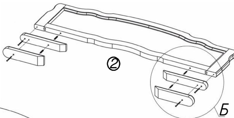
В отверстие перемычки установить шкант (поз.5), затем, при помощи ключа z-образного, закрепить еврвинтом ножку большую (поз.3), затем на шкант установить ножку малую (поз.4) и закрепить еврвинтом (поз. 6).
