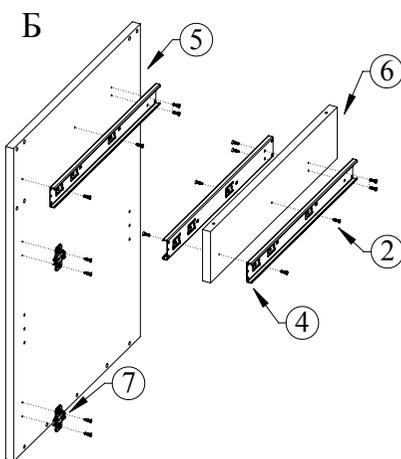
Разъедините чашу и ответную планку петель, скрепленные между собой. Внешние неподвижные планки (4) направляющих прикрепите к боковым стенкам (5) и средней поперечине (6) с обеих сторон. К боковым стенкам (5) тумбы прикрепите ответные планки петель (7).
