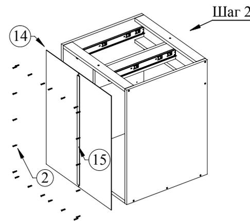
Соедините задние стенки (14) с помощью соединительной планки (15), затем притяните их к корпусу шкафа (шаг 2) саморезами 4х16 (2)
