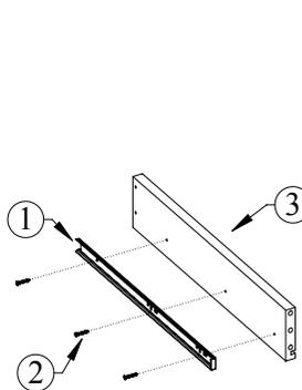
У направляющих нажмите на деблокировочный рычаг, который находится внутри подвижной планки. Снимите внутренние подвижные планки (1) и прикрутите их саморезам 4х16 (2) к боковым стенкам ящиков (3).
