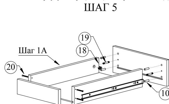
Шкантами (10), эксцентриковой стяжкой [эксцентрик (18), шток эксцентрика (19)] и саморезами 4х30 (20) скрепите в единую конструкцию стенки, дно и фасад ящика
