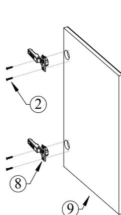
Вставьте чаши петель (8) в отверстия фасадов (9), после чего закрепите чаши при помощи саморезов 4х16 (2)
