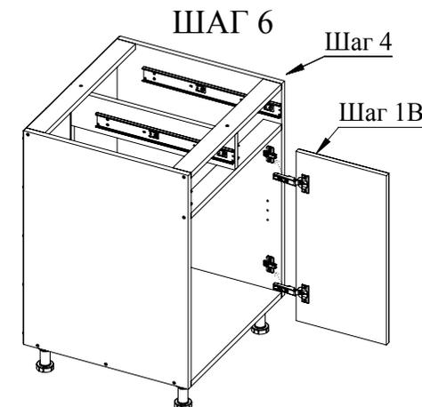
Верхнюю часть петли с креплением быстрого монтажа вставьте в пазы ответной планки, зафиксируйте нажатием сверху (по необходимости отрегулируйте крепежным винтом).
