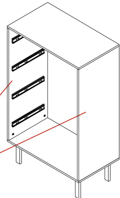
! Обязательно соблюдайте последовательность сборки в инструкции. Верхняя крышка корпуса устанавливается после монтажа задней стенки.
