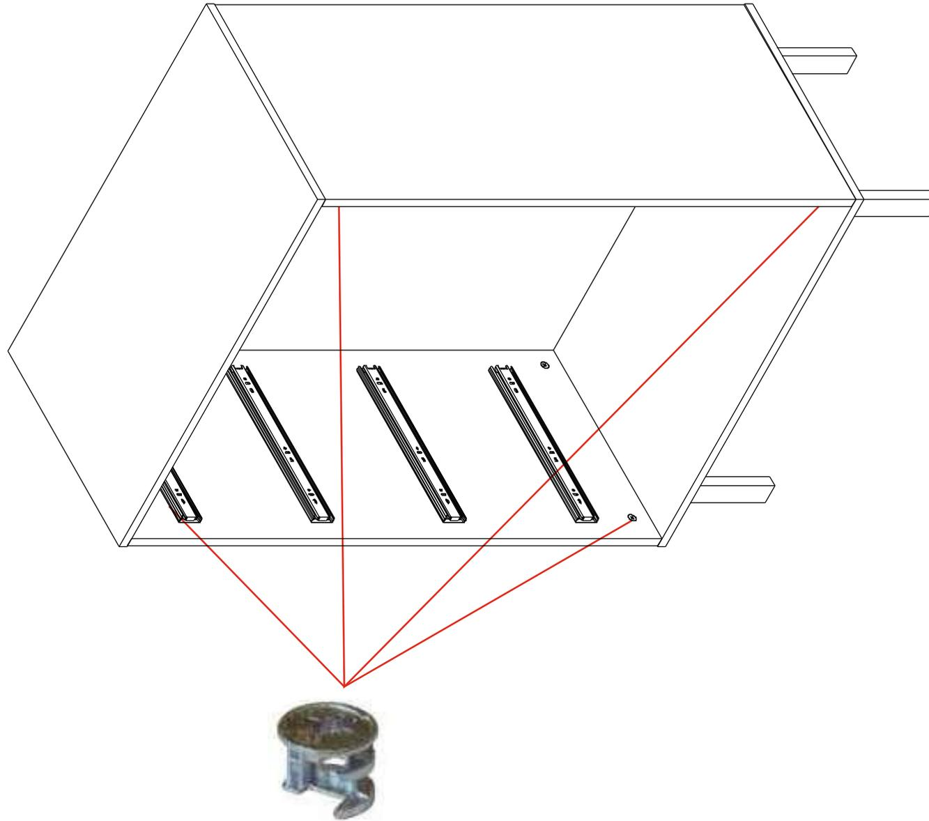
При соединении корпуса необходимо повернуть бочонок эксцентрика для стяжки компонентов
