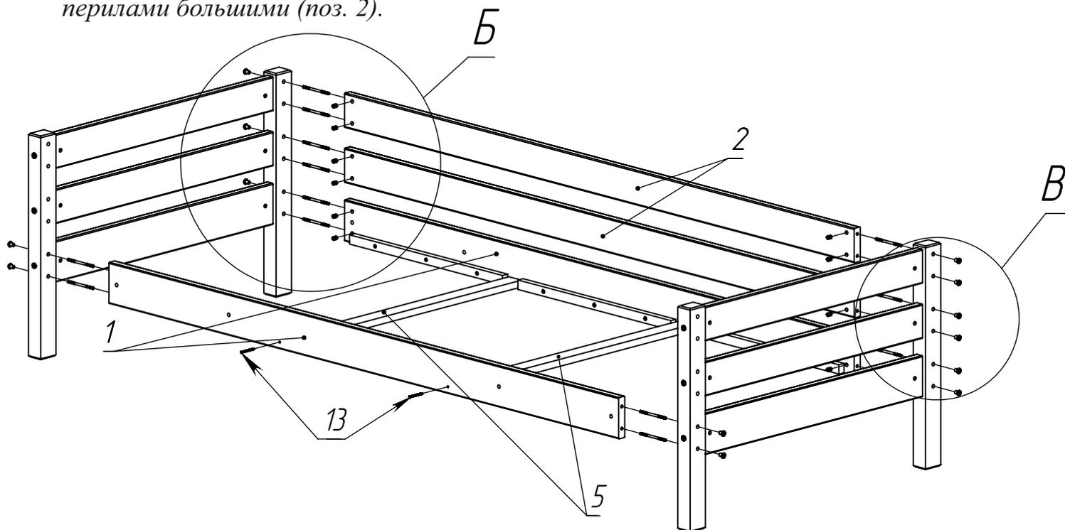
Присоединить царги к спинкам. Гайку ERICSONA (поз. 7) накрутить на шпильку (поз. 9). Вставить муфты-боченки (поз. 8) в отверстия, подставить царгу (поз. 1) к спинке ориентируясь по присадочным отверстиям и при помощи ключа вкрутить шпильку с гайкой ERICSONA. Аналогично присоединить перила большие (поз. 2).
