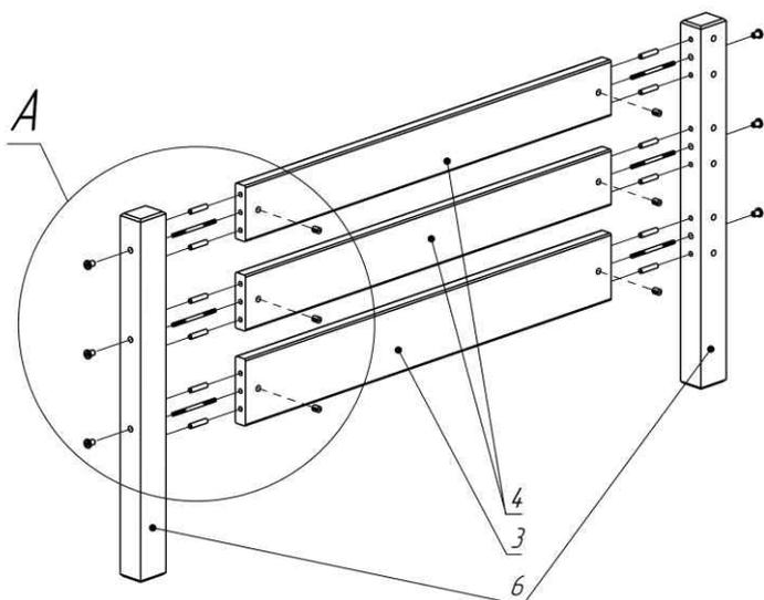
Накрутить гайку ERICSONA (поз.7) на шпильку (поз. 9), вставить в присадочное отверстие на стойке. Вставить шканты (поз. 10) и муфты-бочонки (поз. 8) в отверстия перемычек, при помощи ключа вкрутить шпильки.
