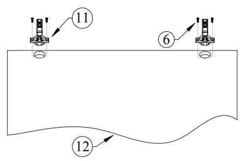
Вставьте чаши петель (11) в отверстия в фасаде (12), после чего закрепите чаши при помощи саморезов 4x16 (6)
