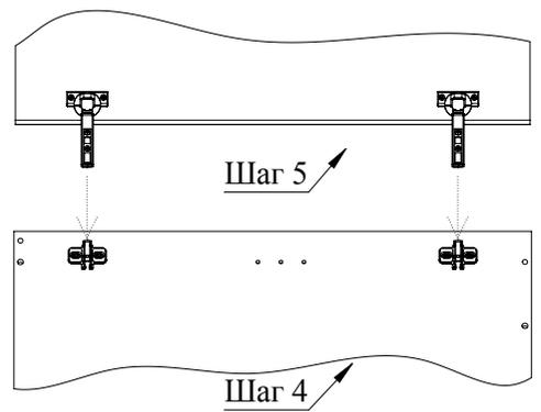
Верхнюю часть петли с креплением быстрого монтажа вставьте в пазы ответной планки, зафиксируйте нажатием сверху (по необходимости отрегулировать крепежным винтом).
