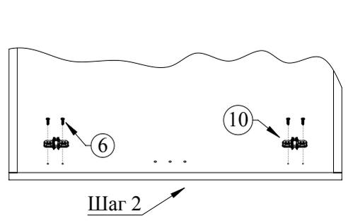
Разъедините чашу и ответную планку петель, скрепленные между собой. Прикрутите ответные планки (10) петель при помощи саморезов 4x16 (6) в размеченные под них отверстия в боковых стенках тумбы
