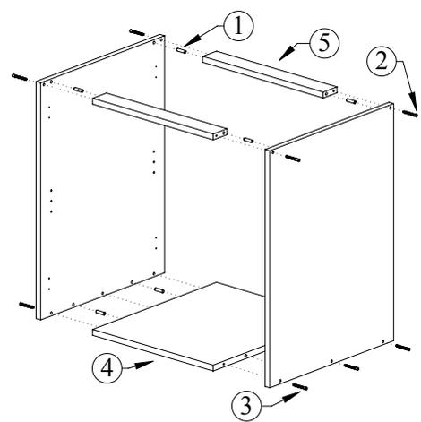
При помощи шкантов (1) и конфирматов (2) скрепите в единую конструкцию боковые стенки (3), основания (4) и поперечины (5)
