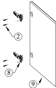
Вставьте чаши петель (8) в отверстия фасадов (9), после чего закрепите чаши при помощи саморезов 4x16 (2)
