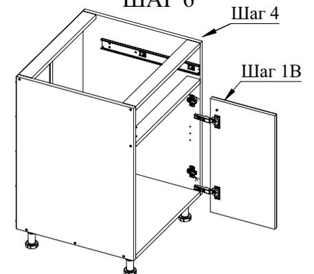
Верхнюю часть петли с креплением быстрого монтажа вставьте в пазы ответной планки, зафиксируйте нажатием сверху (по необходимости отрегулировать крепежным винтом).
