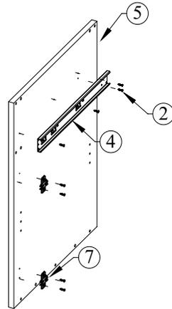
Разъедините чашу и ответную планку петель, скрепленные между собой. Внешние неподвижные планки (4) направляющих прикрепите к боковым стенкам (5). К боковым стенкам (5) тумбы прикрепите ответные планки петель (7).
