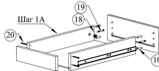
Шкантами (10), эксцентриковой стяжкой [эксцентрик (18), шток эксцентрика (19)] и саморезами 4x30 (20) скрепите в единую конструкцию стенки, дно и фасад ящика
