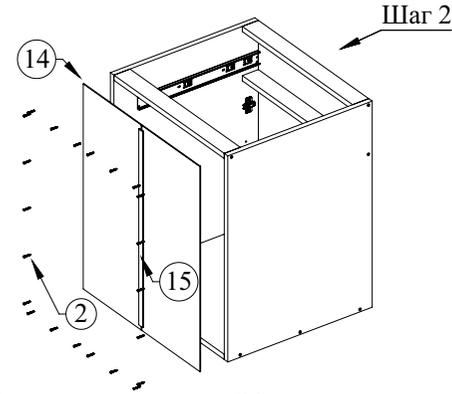
Соедините задние стенки (14) с помощью соединительной планки (15), затем пригните их к корпусу шкафа (шаг 2) саморезами 4x16 (2)
