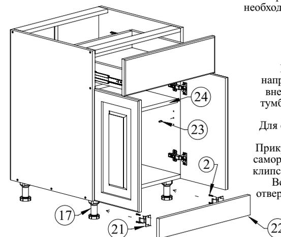
Вставьте ящик внутренними направляющими в подвижные части внешних направляющих в корпусе тумбы. Задвиньте ящик до фиксации деблокировочным рычагом. Для снятия ящика также используйте деблокировочный рычаг. Прикрепите клипсы (21) к коколю (22) саморезами 4x16 (2), затем при помощи клипс прикрепите коколь к ножкам (17). Вставьте полкодержатели (23) в отверстия боковых стенок, установите полку (24)
