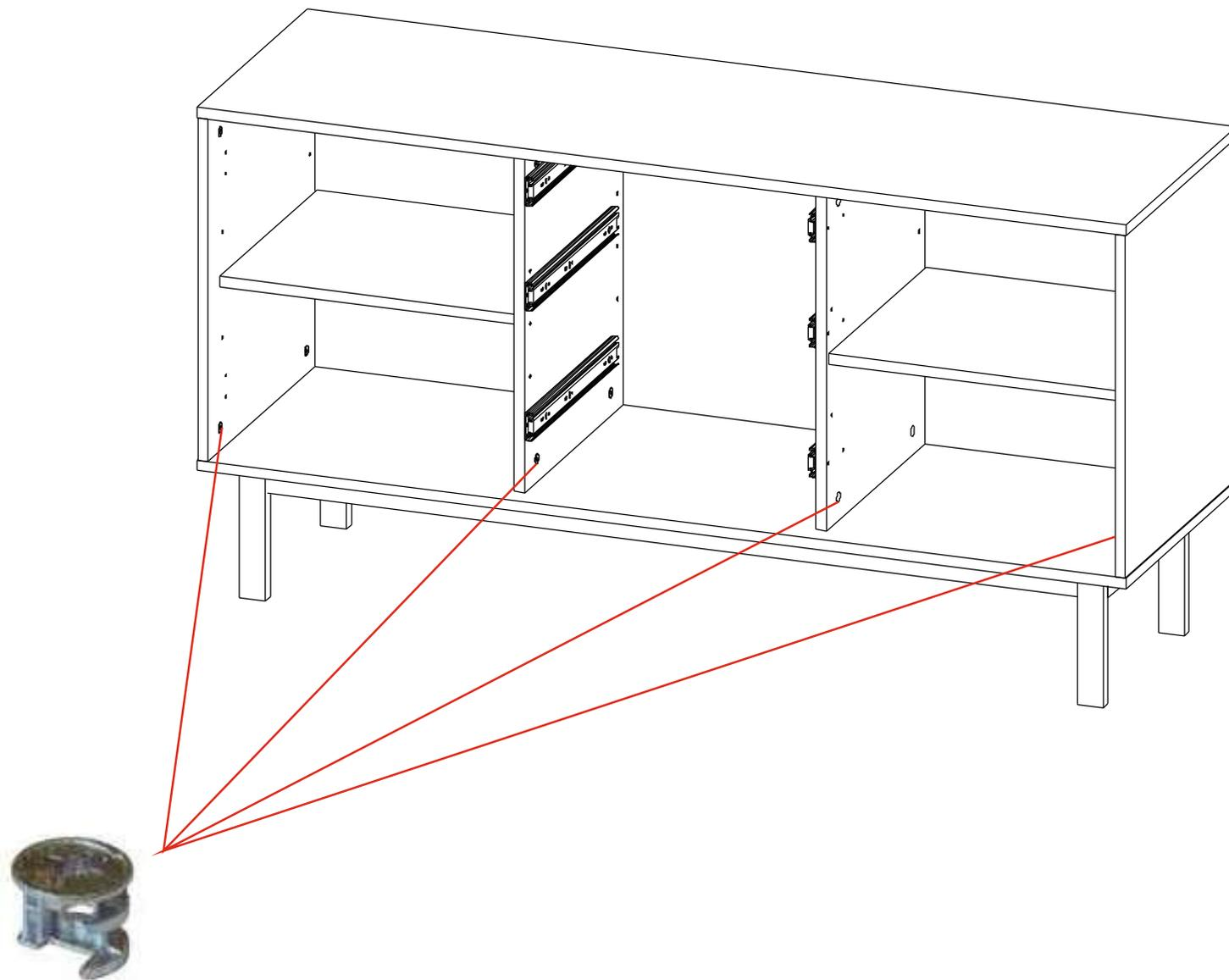
При соединении корпуса необходимо повернуть бочонок эксцентрика для стяжки компонентов
