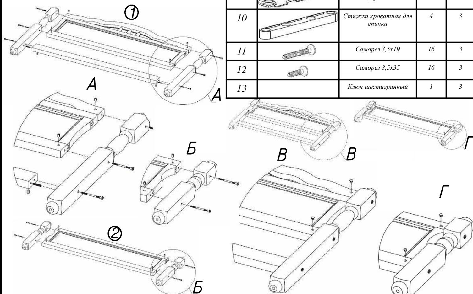
Все соединения (Гайка Ericsona - Шпилька М6х100-Муфта-боченок) рекомендуется затягивать только после установки всех соединений.
