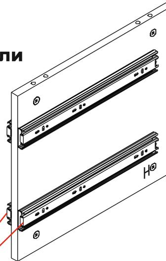
На центральных частях корпуса **направляющие** устанавливаются **с обеих сторон детали**
