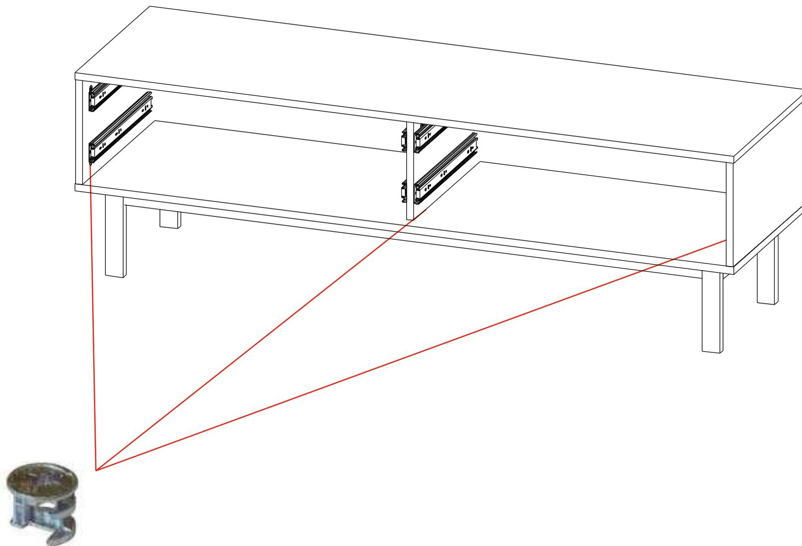
При соединении корпуса необходимо повернуть бочонок эксцентрика для стяжки компонентов
