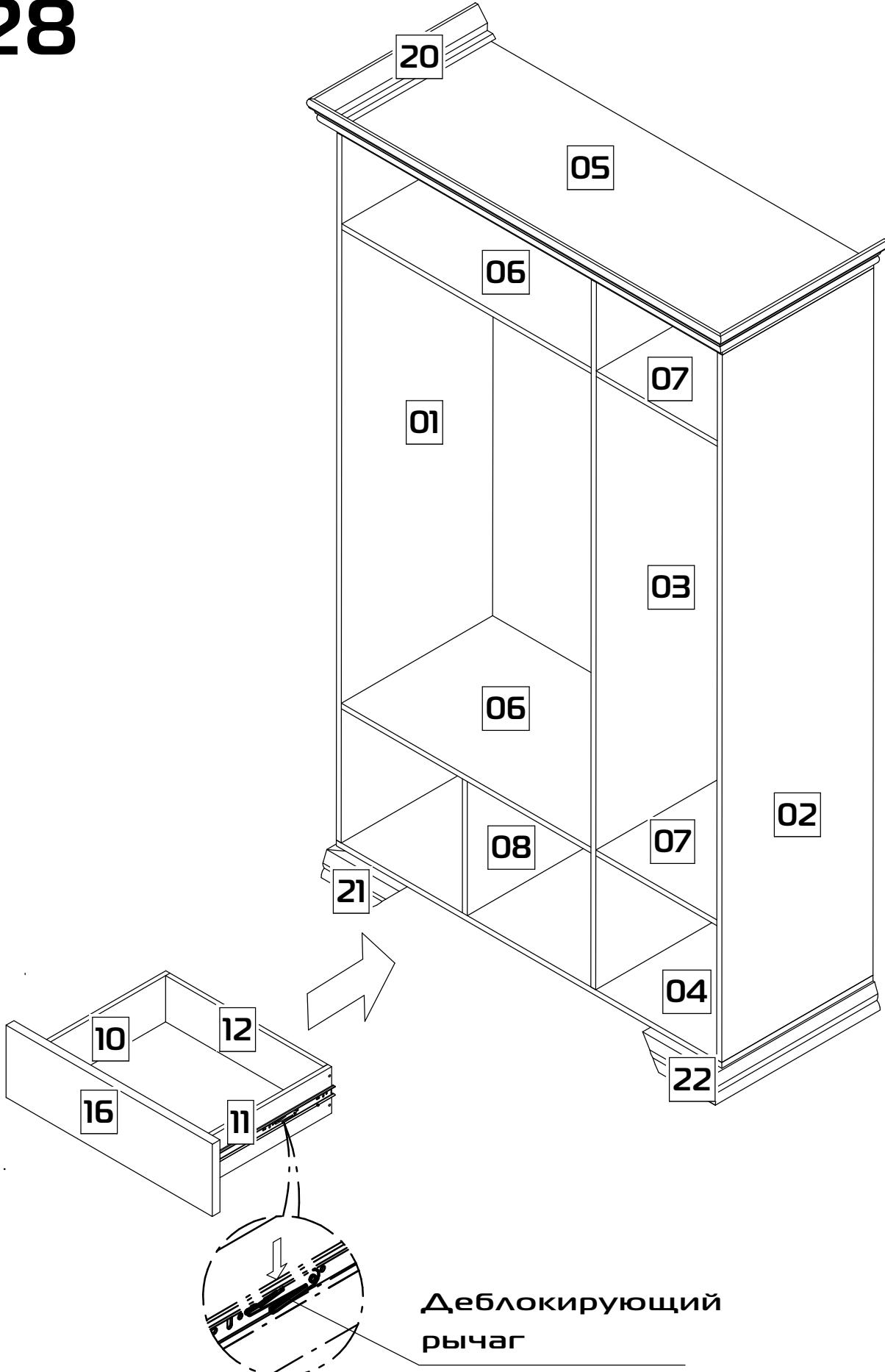
**Нажать на деблокирующий рычаг и вставить внутренние направляющие во внешние, задвинув ящик до фиксации деблокирующим рычагом**
