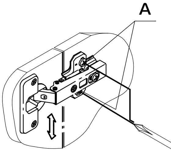
**б) Регулирование глубины**
