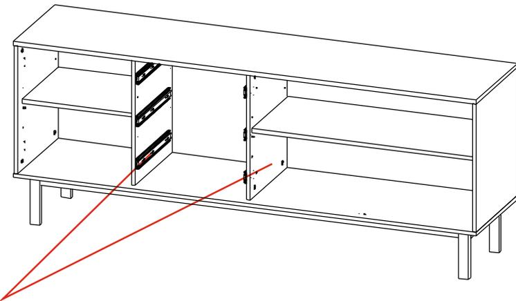
На центральных частях корпуса **направляющие** устанавливаются **с одной стороны**
