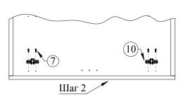
Разъедините чашу и ответную планку петель, скрепленные между собой. Прикрутите ответные планки (10) петель при
