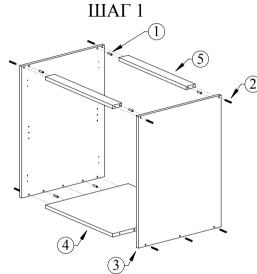
При помощи шкантов (1) и конфирматов (2) скрепите в единую конструкцию боковые стенки (3), основания (4) и поперечины (5)
